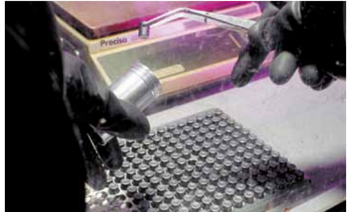
✂ Foto: inspectie van MOX tabletten in een handschoenenkast.
