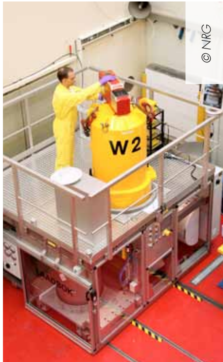
➤ Met behulp van HIRARCHI wordt het ongesorteerde afval uitgesplitst in laagactief LLW (blauw) en middelactief (ILW-L geel en ILW-H rood) radioactief afval. Op deze wijze kan al het afval gesorteerd naar COVRA worden afgevoerd, hetgeen ruimte en kosten bespaart.
