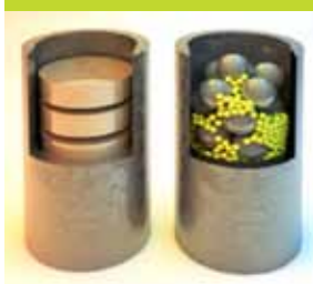
K Figuur 1 - weergave van de splijtstof in pilvorm (links) en Sphere-Pac (rechts)
