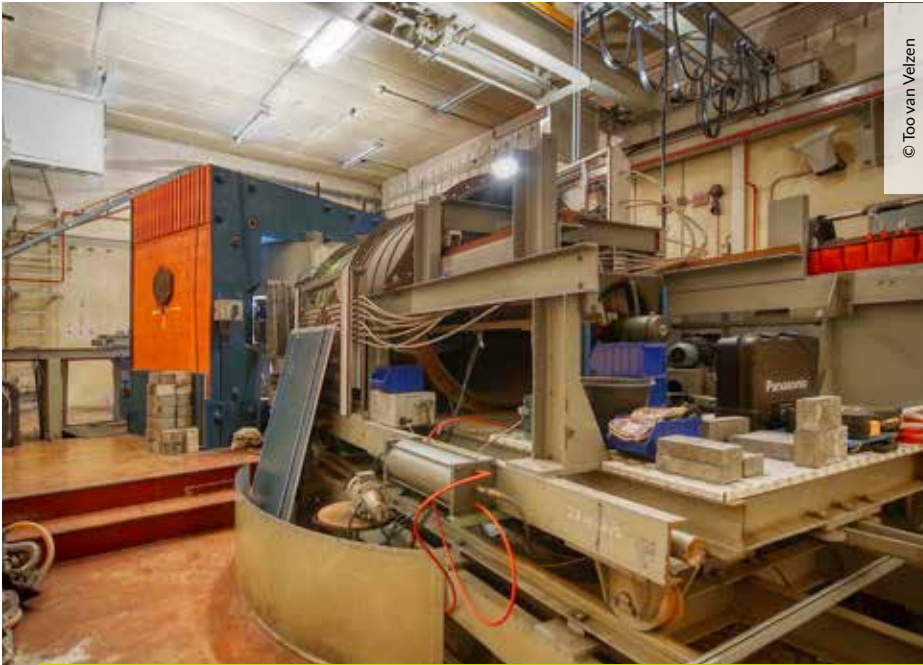
➤ Het Philips-cyclotron staat nog in het gebouw. Het bevat in totaal 90 ton staal en zal in stukken worden afgevoerd naar de COVRA.
