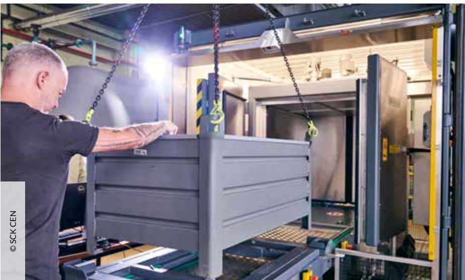
➤ B.E.R.T. heeft een kamervolume van meer dan 1.800 liter en kan goederen meten tot 1.000 kilogram. Hij beschikt daarbij over 24 gammadetectoren.
